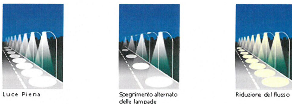
Figura 6 – Corretta uniformità delle luminanze garantita dall'impiego di un regolatore di flusso luminoso
