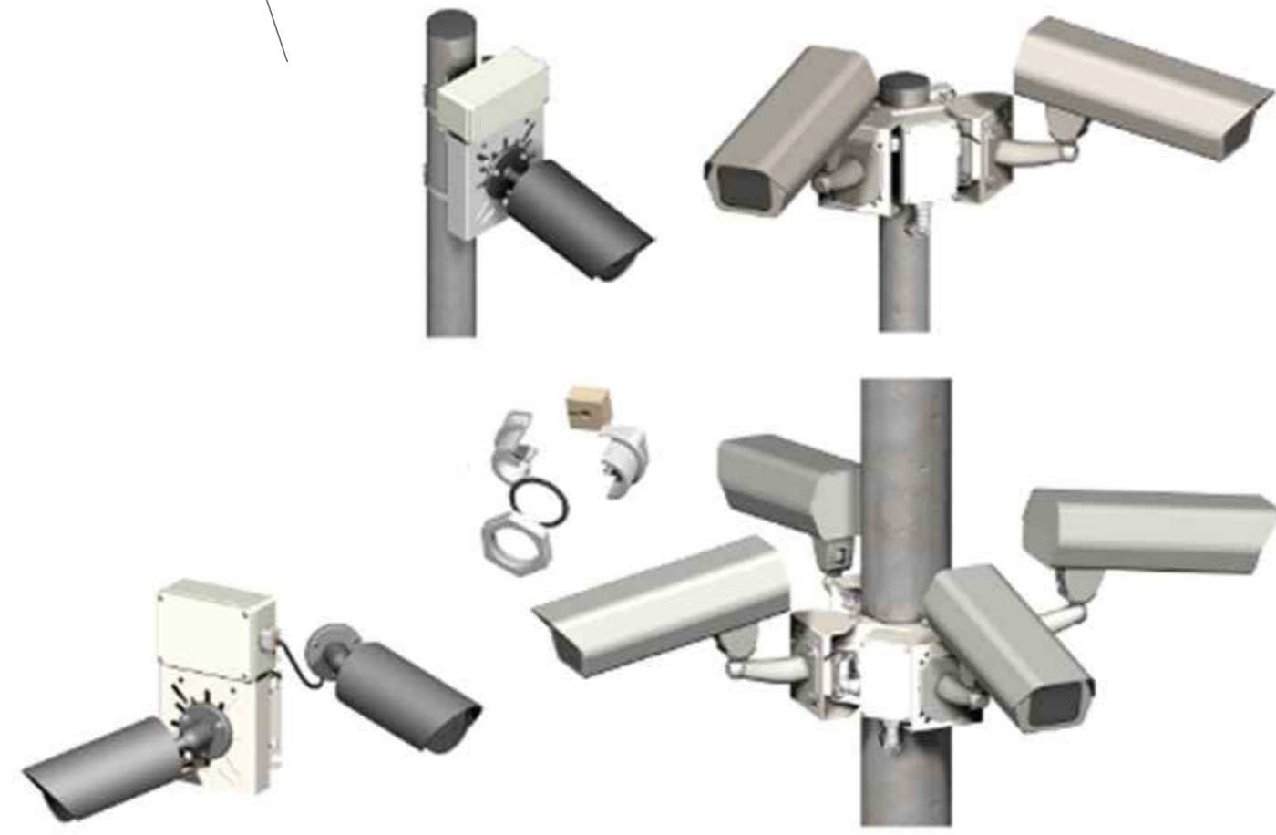
PARTICOLARE INSTALLATIVO APPARATI SU TESTA PALO
